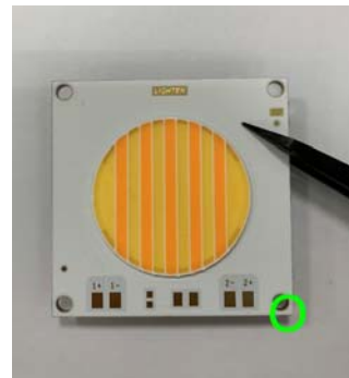
使用塑膠鑷子拿取 Use plastic tweezers
